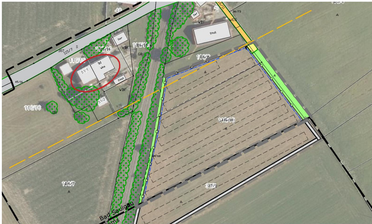
Geplante Ausrichtung der Module und Lage zu möglichen Immissionsorten
